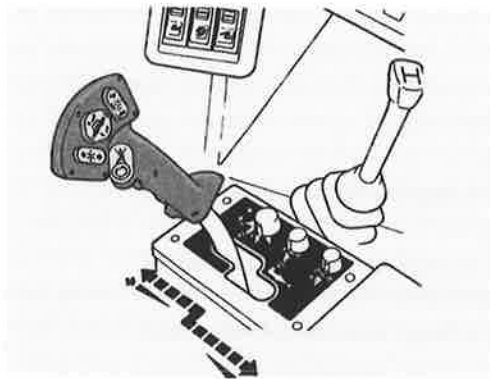
Afb. 1.30 Met de hendel van de hydrostatische rijaandrijving regel je de hoeveelheid olie die naar de hydromotor gepompt wordt.
