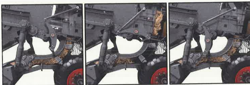
Afb. 4.10 Per slag van de perswagen worden drie laagjes in het perskanaal gebracht. Per drie slagen van de voorpersinrichting maakt de perswagen een slag. © Kamps de Wild BV
