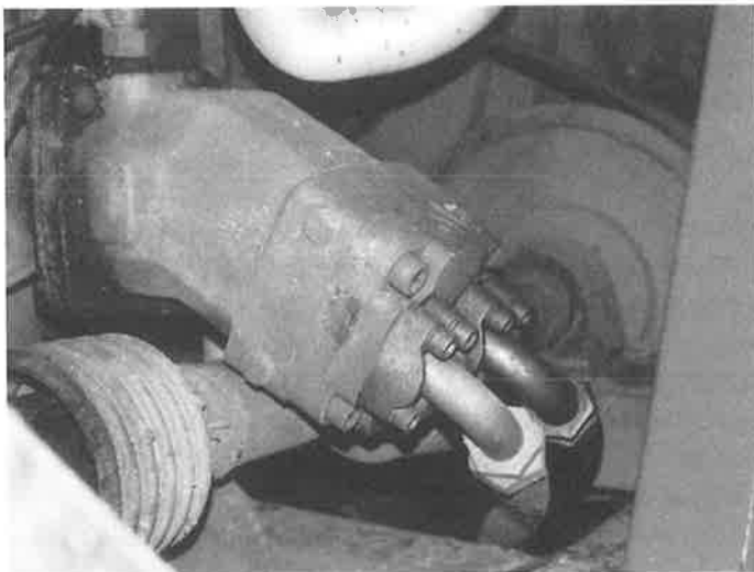
Afb. 2.25 Via een hydromotor worden de wielen aangedreven.
