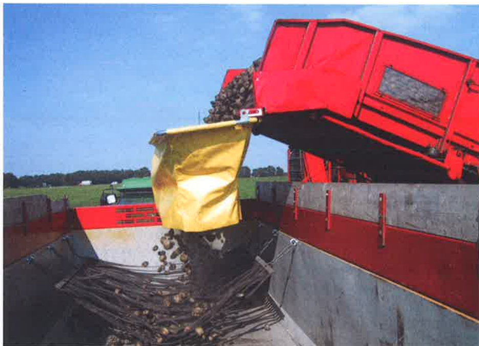
Afb. 5.20 De valbreker zorgt ervoor dat tijdens het lossen van de aardappelrooier de aardappels niet beschadigen.
