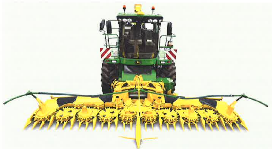
Afb. 3.4 Een voorzetstuk met roterende trommels © John Deere Nederland BV
