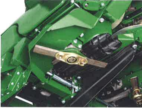
Afb. 1.41 Een stoppelhakselaar © John Deere Nederland BV
