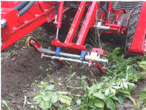
Afb. 5.10 Automatische besturing van de aardappelrooier © Grimme NL BV
