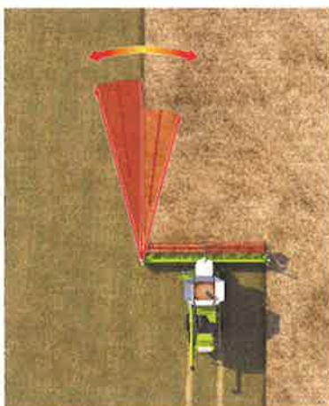
Afb. 1.48 Bij een laserbesturingssysteem hoef je zelf niet meer te sturen. © Kamps de Wild BV
