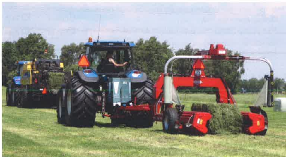
Afb. 4.29 Vlerkante silagebalen worden in plastic gewikkeld. Hierdoor ontstaat een verteringsproces waarbij kuilvoer ontstaat.
