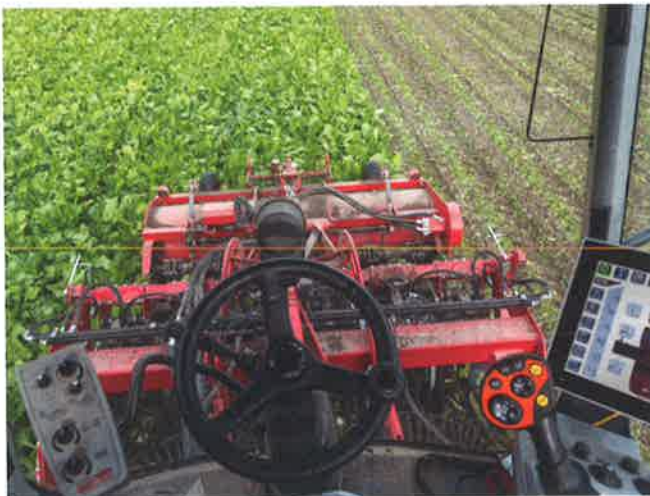
Afb. 2.20 De stuurcabine. Met een bedieningsterminal op de stuurkolom, een bedieningsterminal in de armleuning en een bedieningsscherm veldmodus.
