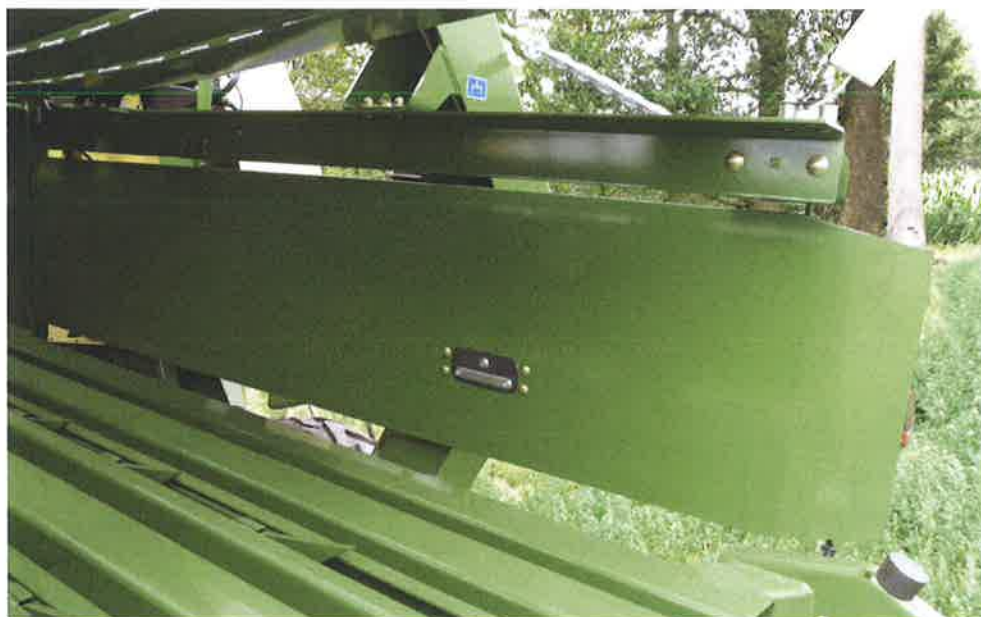
Afb. 4.26 Drogestofsensor in het perskanaal
