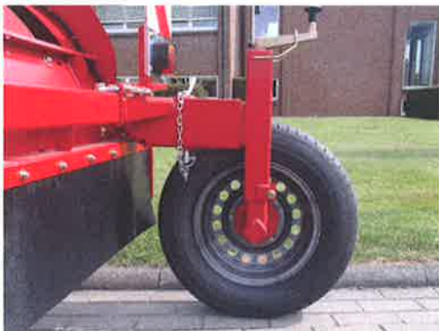
Afb. 5.24 Bij de meeste loofklappers verander je de werkdiepte door de loopwielen omhoog of omlaag te draaien.
