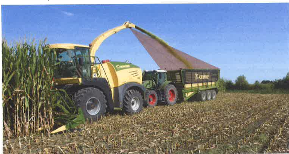
Afb. 3.17 Werking van het automatisch laden © Krone
